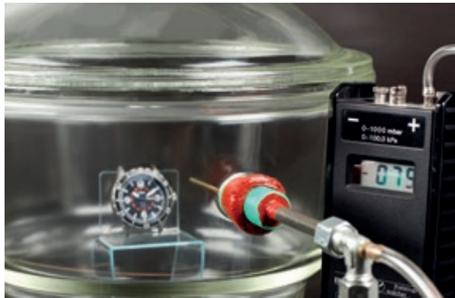
真空乾燥器での気圧差試験。857 UTC VFRなどのDIN 8330準拠のパイロットウォッチは数千回の圧力変化負荷に耐えなくてはなりません。
