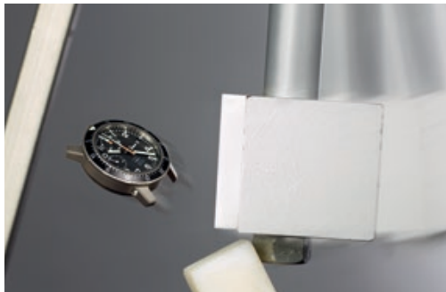
衝撃に対する耐性のテスト装置。写真は103 Ti IFRのテスト。
