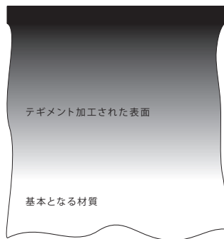
テギメント・テクノロジーで硬化された表面と、その上に施されたハード・コーティングを図式で表します。
