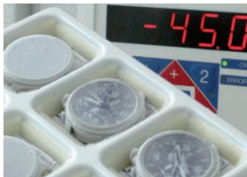
温度試験機を使った -45^{\circ}\text{C} ～ +80^{\circ}\text{C} における個別検査。
