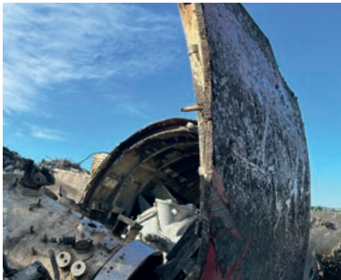
206型潜水艦の内側の板厚は、高度な強化構造のおかげで、想像されるよりもはるかに薄いものです。
