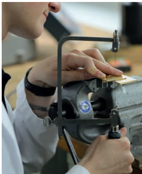
ホイールブランク用の黄銅板をのこぎりで切り出します。
