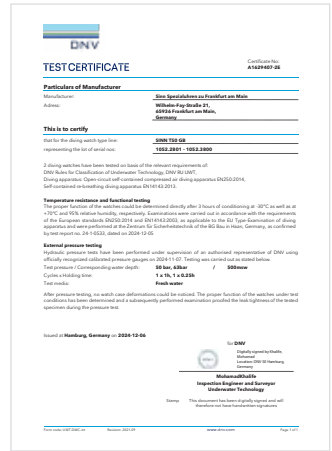
シリーズ T50GB では、水深500mまでの耐圧性、ならびに欧州潜水器具規格EN250とEN14143に準拠した温度耐性および機能がDNVにより認証されています。
