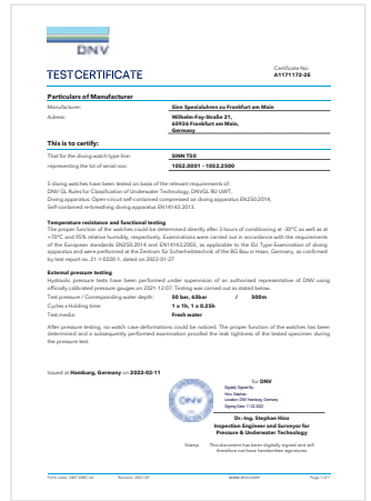
T50とT50 GBDR では、水深 500mまでの耐圧性、並びに欧州潜水器具規格EN250とEN14143に準拠した温度耐性および機能がDNVにより認証されています。
