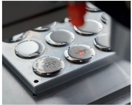
精密なレーザー装置によって丹念に裏蓋に刻印を施します。
