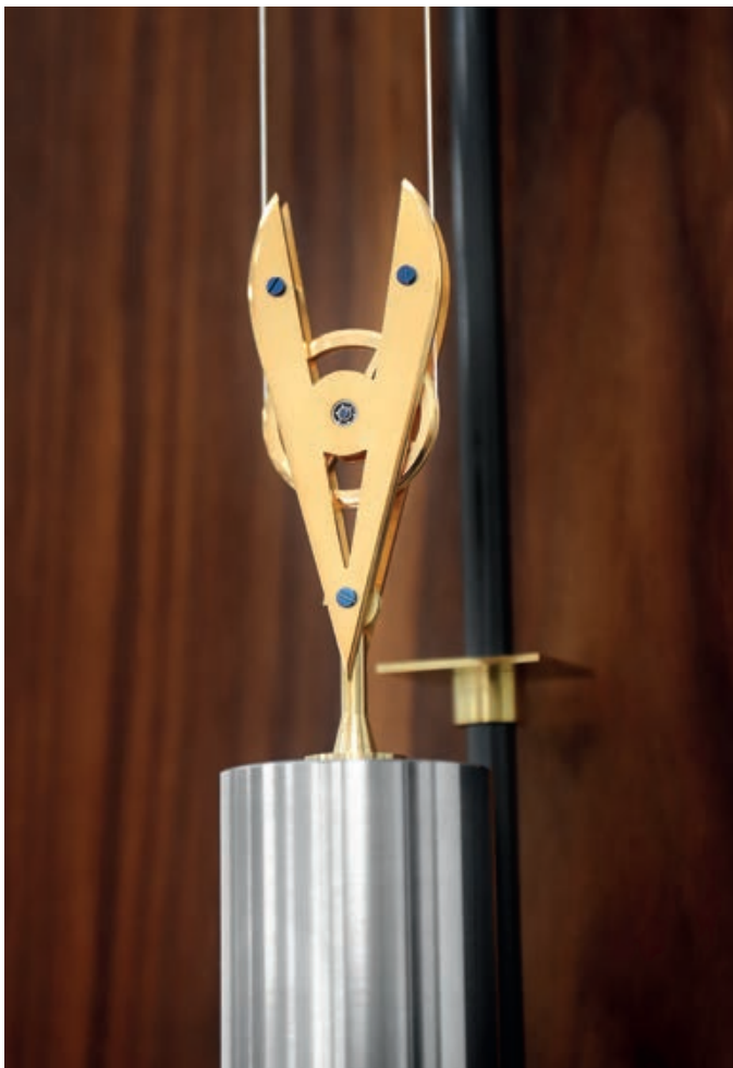
滑車は、重りの「落下高さ」が同じ状態において動作時間を延長する役割を果たします。
