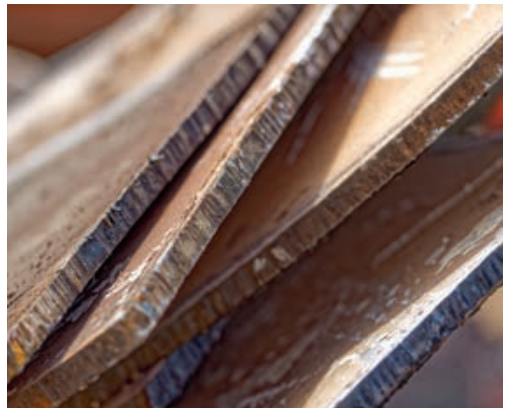
ドイツの非磁性潜水艦鋼の平板。後続の加工のためにまずは真っすぐにする必要があります。
