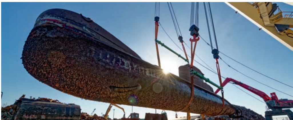
フローティングクレーンは、重量約450トンのU 15潜水艦を、グレードルと呼ばれる台に降ろします。ここで潜水艦は、艦体が分割されるまで安定した位置に留まります。
