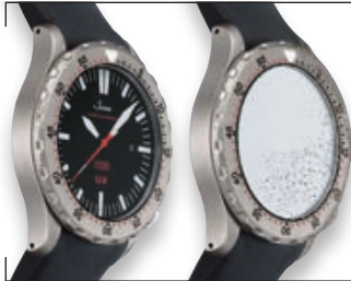
UX (EZM 2B) は水面下でもあらゆる角度から視認できます。オイルが充填されていない時計は、水中では約45°以上の角度で鏡のように全反射してしまいます。
