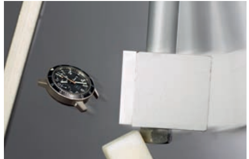
衝撃に対する耐性のテスト装置。写真は103 Ti IFRのテスト。
